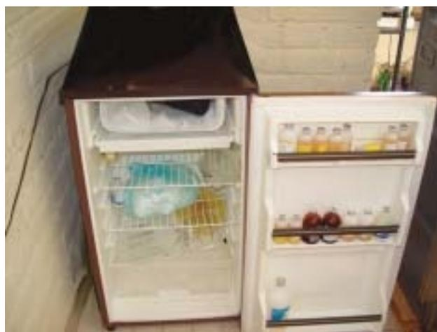
Compruebe a diario su estado general. Debe funcionar entre 2 - 8°C. Si no mantiene la temperatura ajuste los controles, compruebe el aislamiento y que la puerta cierra correctamente. Si el refrigerador falla a menudo debe ser reemplazado.
